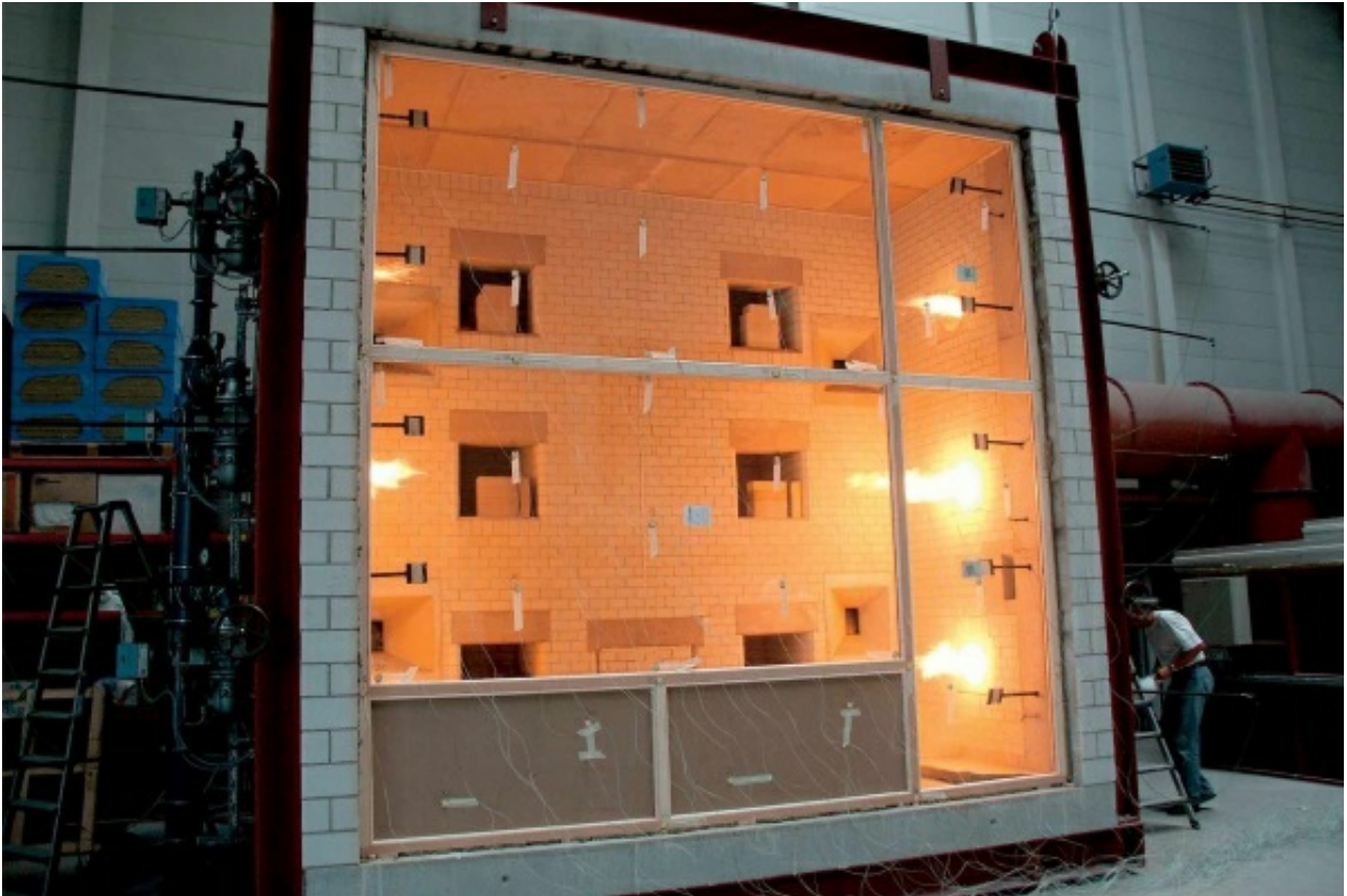
Image: Four de cuisson laboratoire de Glas Trösch FIRESWISS
